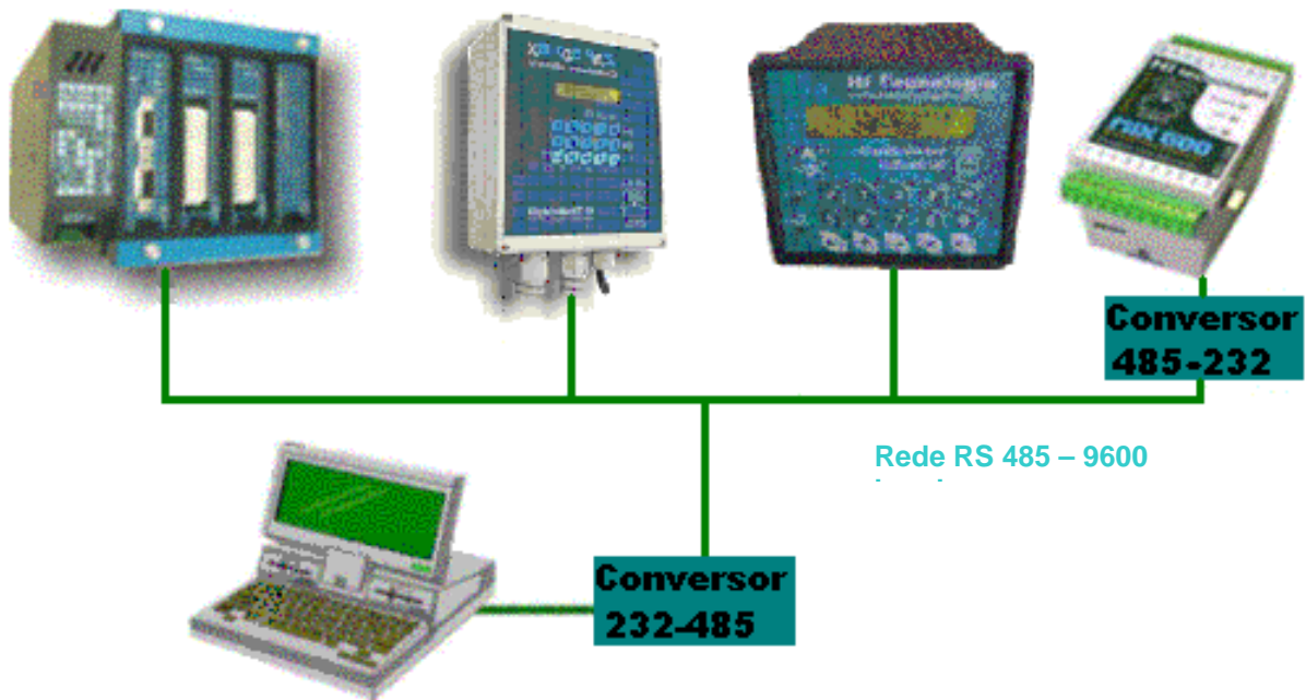
Figura 1: Controladores HI em rede supervisionados por PC
