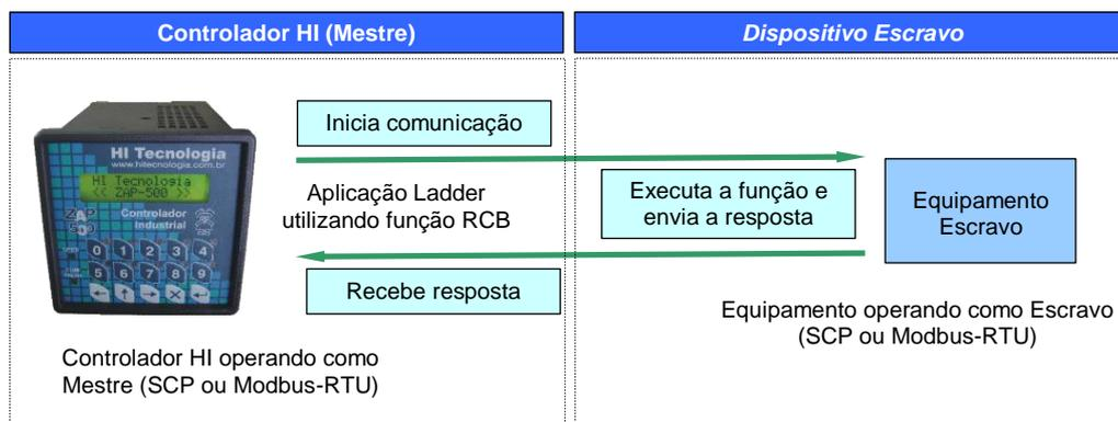
No caso do controlador HI possuir dois canais de comunicação serial disponíveis, o canal que estiver configurado como mestre será automaticamente utilizado para executar as funções de troca de dados especificadas através das funções RCB do programa de aplicação.
