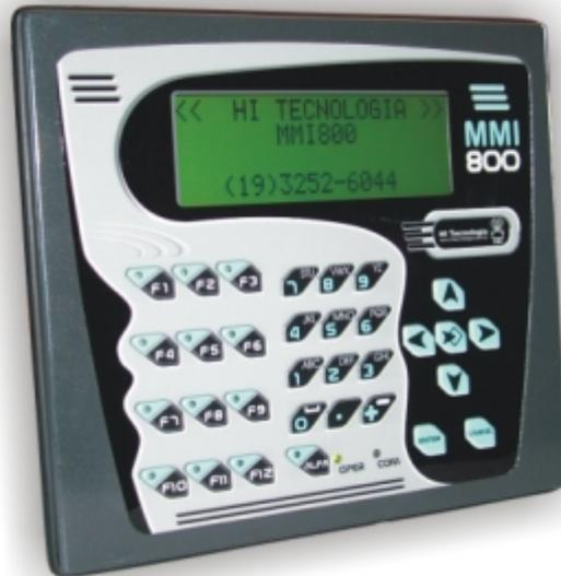
O Painel de Operação MMI800 é uma IHM (Interface Homem Máquina) para ambientes industriais desenvolvida para integração com CLP's (Controladores Lógicos Programáveis) e equipamentos de supervisão e controle. Com um *display* de 4 linhas e 20 caracteres por linha, possui caracteres grandes (4.84 x 9.22mm) de fácil visualização e *backlight* programável.
