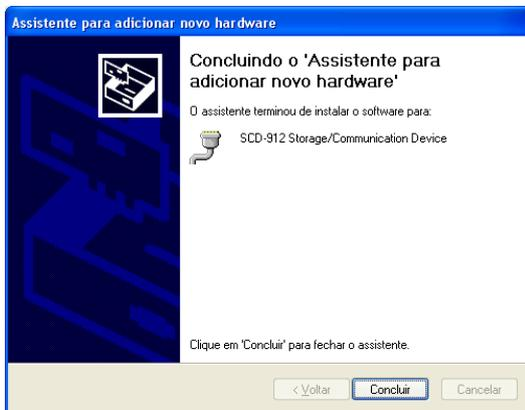
Terminado o processo, o Windows irá criar uma porta COM virtual associada a este dispositivo, denominada “SCD-912 Storage/Communication Device (COM#)”, onde # especifica o nro da porta COM associada.
