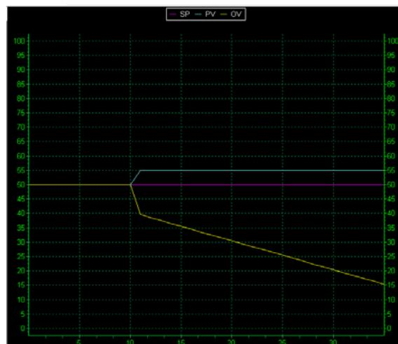
**Figura 26: Gráfico de Supervisão de PID no controle Invertido**
