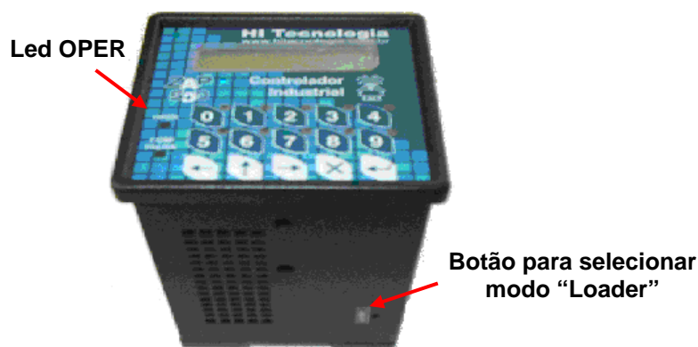
Figura 3: Localização do botão Loader no Controlador ZAP500 série II
