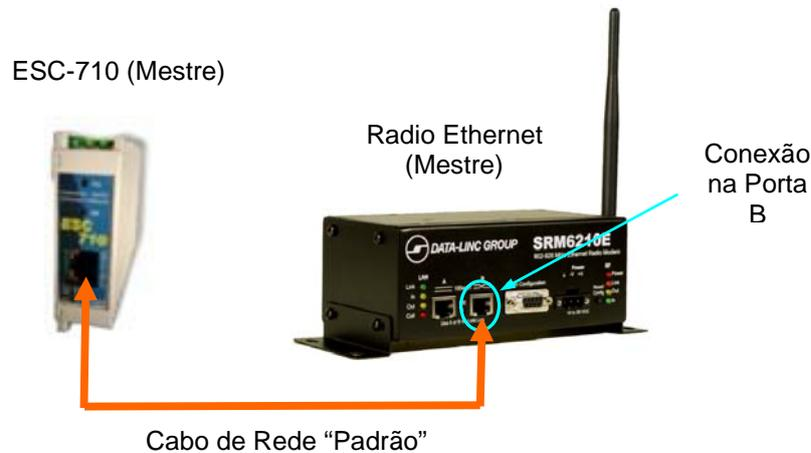
Figura: Conexão com a Porta B do Rádio Ethernet
