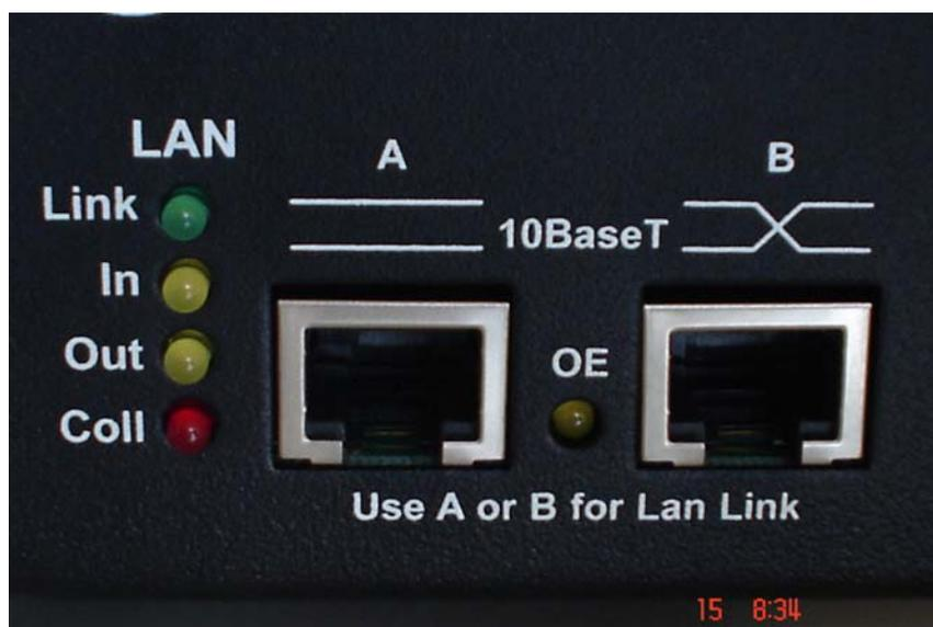
A escolha de qual conexão (A ou B) utilizar é dependente do tipo de cabo a ser utilizado entre o rádio e o equipamento.
