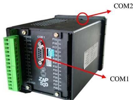
Este controlador possui um conjunto de chaves, do tipo "Dip Switch", localizado no painel traseiro do equipamento. As chaves 1, 2, 3 e 4 desta dip switch configuram o tipo de comunicação serial a ser utilizada pelo canal COM1. Este canal serial pode ser configurado para operar como RS232-C (incluindo linhas de controle de modem), RS422 ou RS485, permitindo comunicação ponto a ponto ou em rede do tipo multidrop.
