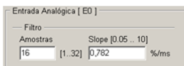
Figura – Tela de configuração do número de amostras e taxa de variação da entrada analógica (DXM510)
