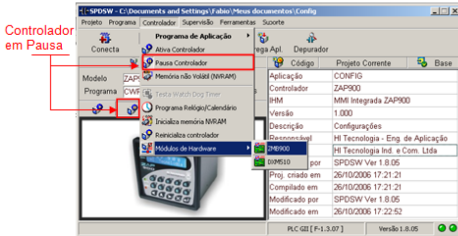
Figura – Aplicativo SPDSW com os passos necessários para entrar na tela de configuração dos módulos
