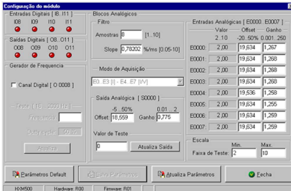
Figura – configuração das entradas analógicas (E4...E7) do módulo HXM500 – 2 a 10 Volts
