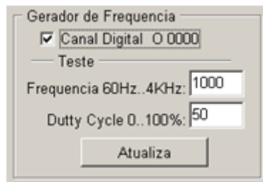
Figura – Configuração da saída O0 (módulo ZMB900) como gerador de frequência.
