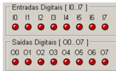
Figura – Aquisição / atuação digital do módulo ZMB900
