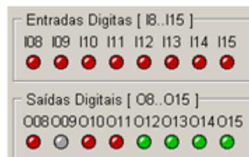
Figura – Aquisição / atuação digital do módulo DXM510
