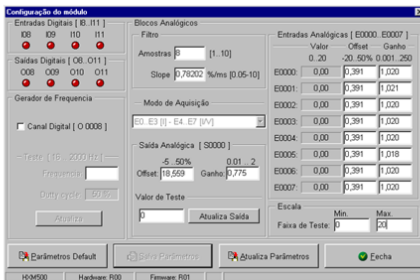
Figura – configuração das entradas analógicas (E0...E7) do módulo HXM500 – 0 a 20 mA
