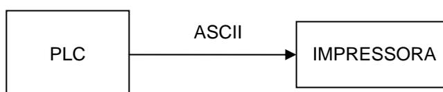
O bloco SCB de envio de frames ASCII pode ser utilizado para configurar e enviar comandos para a impressora associada em qualquer dos PLC's
