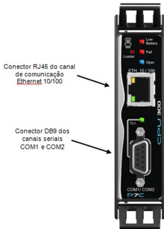
Figura: Conectores de comunicação da CPU300
