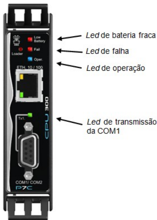
Figura: Leds da CPU300 do P7C
