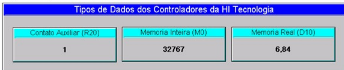
Figura 64 - Aplicação de exemplo dos tipos de Tags disponibilizados por controladores da HI Tecnologia
