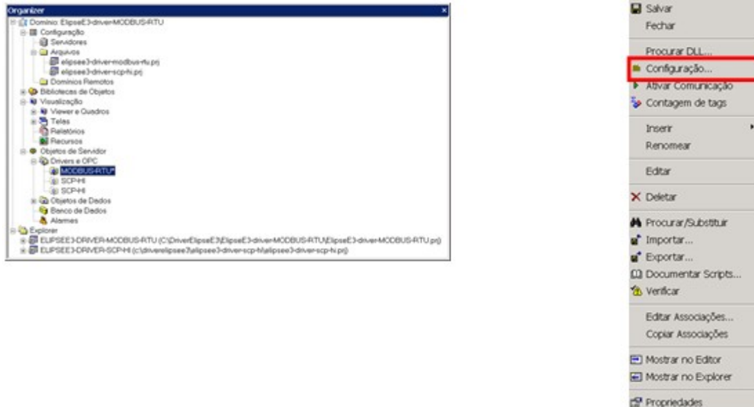
Figura 105 - Para ter acesso às funções de configuração do Driver MODBUS-RTU
