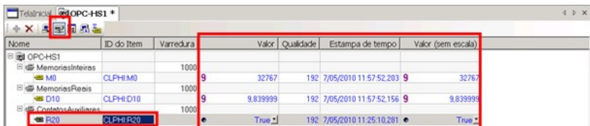
Figura 148 - Configuração e teste de um Tag denominado R20
