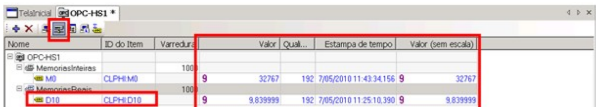
Figura 145 - Configuração e teste de um Tag denominado M0
