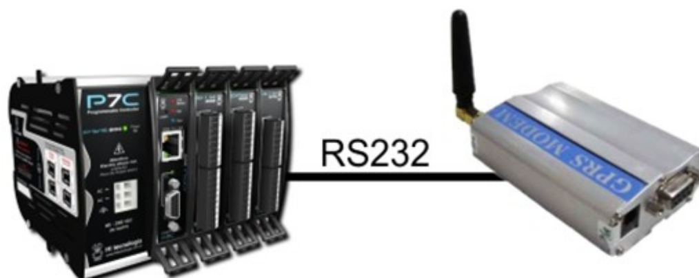
Figura – Controlador da HI Tecnologia conectado a um modem GPRS
