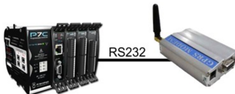
Figura I Controlador da HI tecnologia conectado a um modem GPRS
