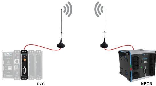
Neste cenário o controlador P7C¹ pode trocar dados com o controlador NEON, através do link wireless entre o módulo WCM611 (do controlador P7C) e o módulo CPU400 (do controlador NEON).
