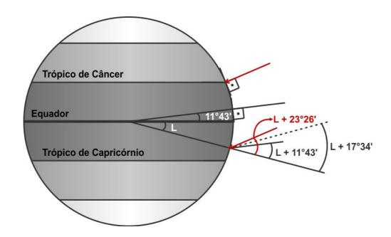
Por fim a recomendação é instalar o painel solar voltado para o hemisfério oposto, com inclinação (em relação à horizontal):
