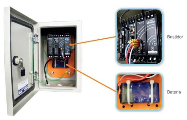
Dependendo do modelo de controlador e do seu respectivo consumo, existe a possibilidade da bateria ser acoplada internamente ao bastidor, no slot disponível ao lado do módulo eletrônico SPM100.
