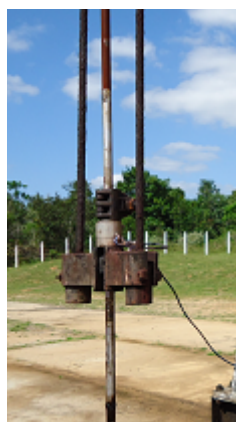
Figura 5 - Célula de carga e sensor de posição da unidade de bombeio mecânico
