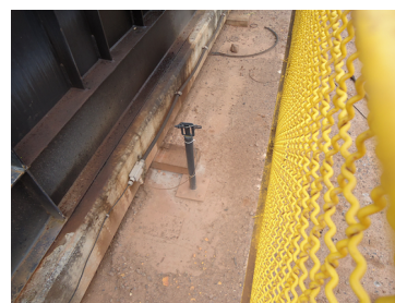
Figura 5 - Célula de carga e sensor de posição da unidade de bombeio mecânico
