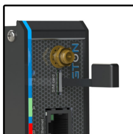
Remoção do cartão nano SIM Card com a ferramenta.
