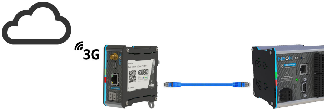
PLC conectado à internet via GTON-M E3G | ENB.
