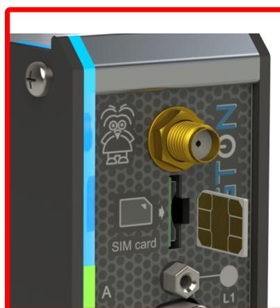
**Encaixe do nano SIM Card no equipamento.**
