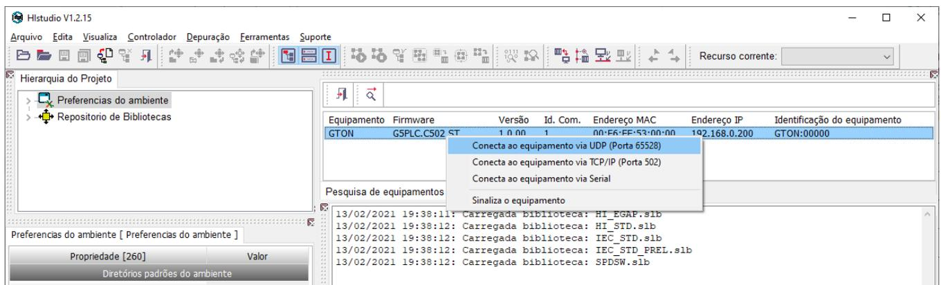
Selecione o GTON-M na lista de equipamentos encontrados na rede e após, clicar com o botão direito do mouse sobre o item para apresentar o menu conforme indicado na figura. Selecione a opção, **Conecta com o equipamento via UDP (porta 65528)**.
