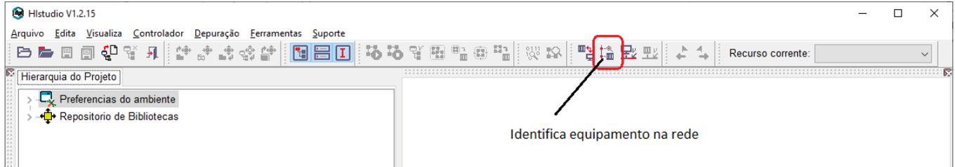
Com o modem conectado na mesma rede do computador que esta rodando a o Hlstudio pressione o botão indicado na figura (**Identifica os equipamentos presentes em uma rede ethernet [CTRL+F11]**) para procurar o GTON-M na rede. Se o processo ocorrer com sucesso a tela a seguir sera apresentada.
