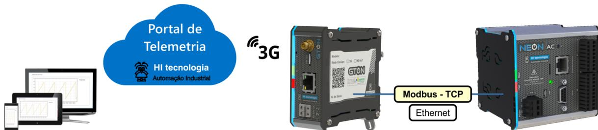
**PLC NEON conectado ao Portal Telemetria via GTON-M E4G.**
