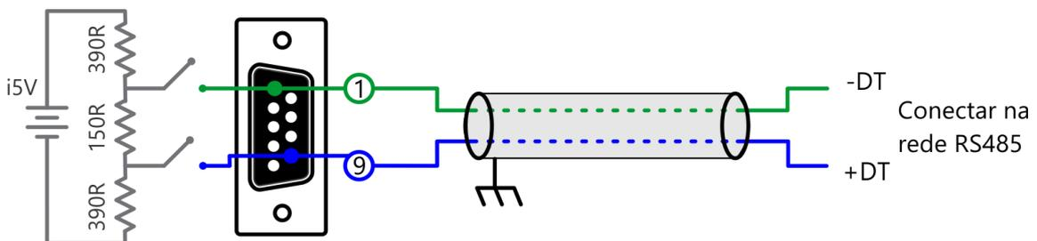
**Configuração do cabo de comunicação quando utilizado a rede RS485. Conector visto pelo lado da solda.**
