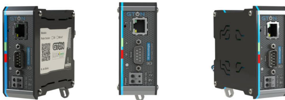
O GTON-C SET é um conversor serial RS232-C / RS485 para uma rede Ethernet 10/100 Mbits, e também opera como bridge Modbus-TCP / Modbus-RTU. Provê acesso através de uma rede Ethernet a dispositivos com interface de comunicação serial. Este acesso é realizado de forma transparente utilizando uma porta serial virtual, ou o próprio endereço IP do GTON-C SET.
