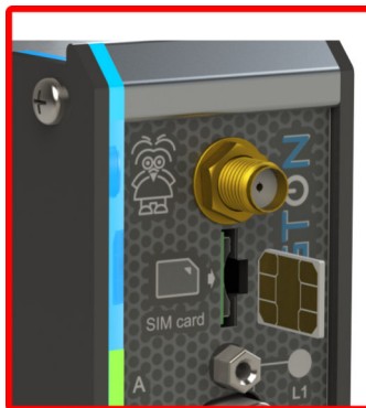
Encaixe do nano SIM Card no equipamento.
