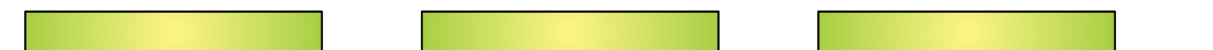
Representação da piscada do LED L2 para os valores de Status = 15, piscada longa.
