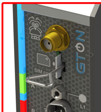
Remoção do cartão nano SIM Card com a ferramenta.
