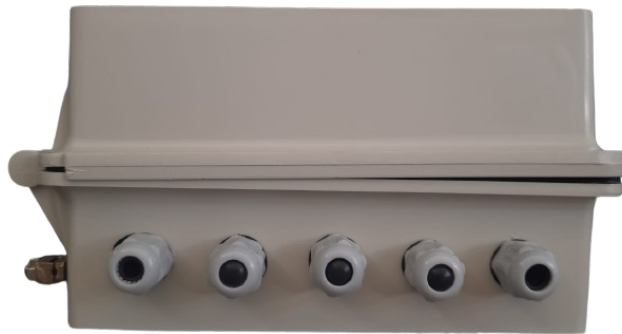
Figura 3 - Painel de Aquisição e Monitoração de dados, vista inferior, entrada para cabos
