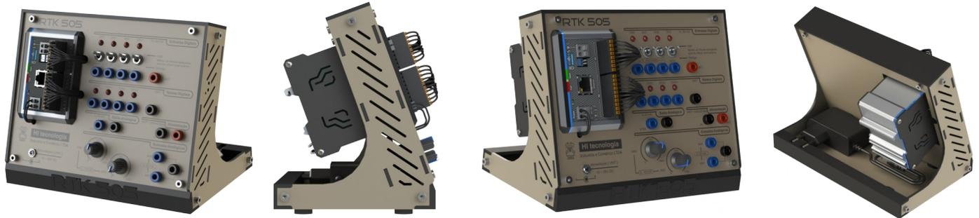
Flexível e adaptável, o kit oferece a opção de gerar sinais de entrada tanto manualmente pelo usuário quanto por meio de sensores reais conectados através de bornes tipo banana. As saídas digitais podem ser facilmente conectadas a diversos dispositivos externos, como relés, válvulas solenoides e lâmpadas, permitindo uma ampla gama de experimentos práticos.
