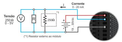
Exemplo de utilização da saída analógica em tensão, de 0 a 5V, utilizando um resistor externo.
