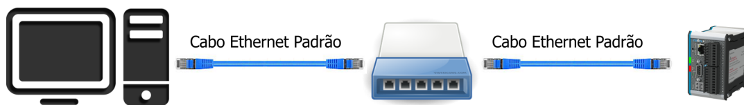
Exemplo de conexão via rede ethernet entre um PC e o controlador RION+.
