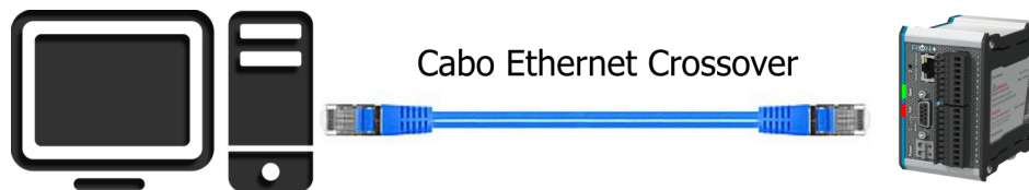
Exemplo de conexão direta entre um PC e o controlador, via canal Ethernet.
