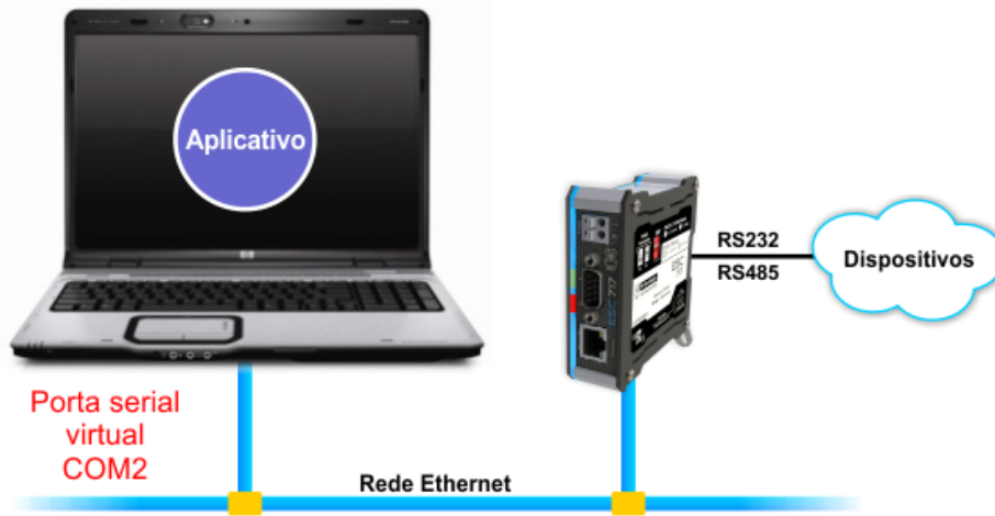
Exemplo de aplicativo utilizando um driver serial mapeando em uma porta serial virtual para o ESC717.
