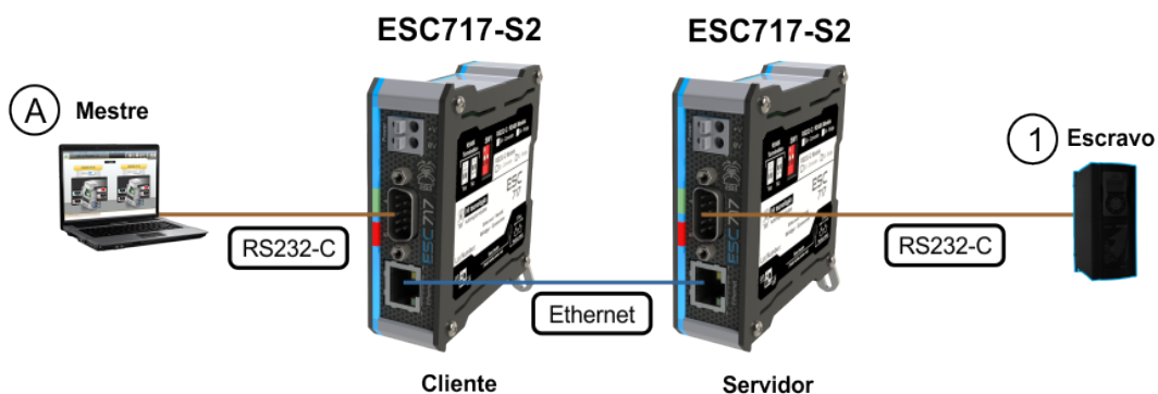
Exemplo de acesso a um dispositivo serial através de dois ESC717, um operando como Cliente e outro como Servidor.
