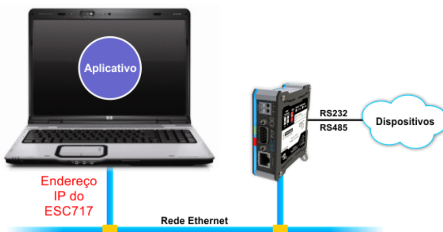
Exemplo de aplicativo utilizando um driver Ethernet mapeando diretamente no endereço IP do ESC717.
