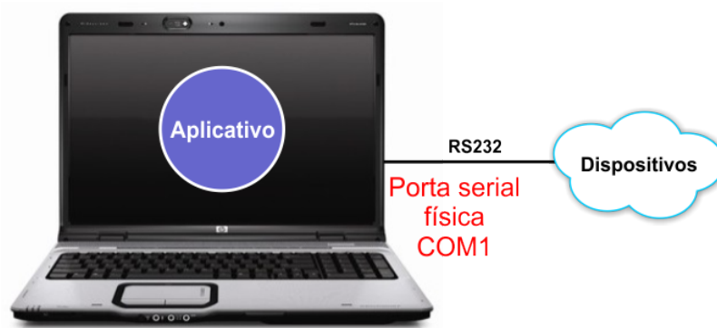
Exemplo de aplicativo que utiliza uma porta serial para se conectar com um dispositivo.
