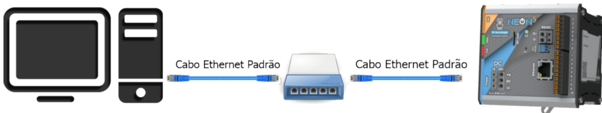
Exemplo de conexão via rede ethernet entre um PC e o controlador.
