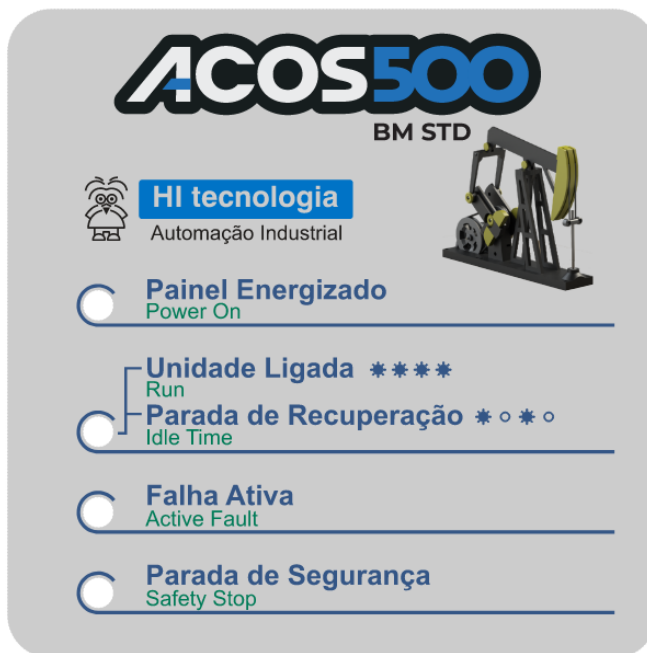
Figura 5 - Adesivo com as informações do status do poço
