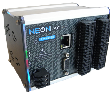
Figura 5 - Controlador NEON AC, com módulos de I/O HIO120 e HIO140 (imagem ilustrativa)
