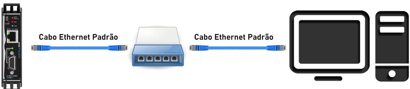
**Conectando o módulo CPU302 em rede ethernet.**
