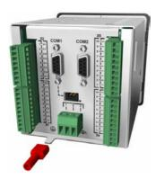
Utilizar conector faston 6.3 totalmente isolado para cabo de 1mm verde e amarelo.
